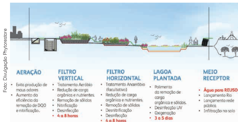
Fluxo do Efluente Sanitário Industrial
